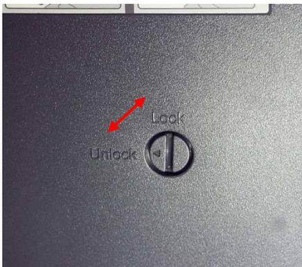
透過原稿ユニットの内側にあるキャリッジロック（輸送時固定ネジ）を Unlock 側へ回転します。
