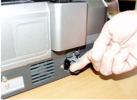
キャリッジ（心臓部の光学ユニット）の固定装置『キャリッジロック』を解除します。レバーを持ち上げて、UNLOCK側にスライドします。
