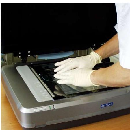
ゲルを痛めないように注意しながら、プラテンガラスとゲルの間の気泡を抜きます。最後にゲルの上に水をかけて平滑にします。長時間スキャンする場合は、サランラップを被せ、セロテープなどで、サランラップの皺をのばして、ピンと張ると乾燥を防ぐことができます。皺の無い状態のサランラップは、スキャン画像に影響しません。
