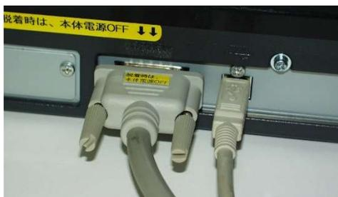
USB ケーブルを GELSCAN-3 背面に接続します。もう片方を PC の USB ポートに接続します。初めてソフトウェアを PC にインストールした後の最初の 1 回目は、USB ケーブルを接続した直後、スキャナが自動認識されます。(名称: DS-G2000)。その後、スキャナ用ドライバー (TWAIN datasource) が自動的にインストールされます。
