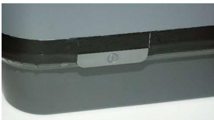
GELSCAN-3 は、電源投入時に光源の光量に応じて校正 (キャリブレーション) を行います。Ready (緑色) ランプが点滅している間は、使用できません。Ready ランプが連続点灯状態になりましたら次に進みます。
