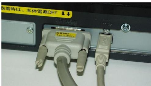
USB ケーブルを IRGB-6500 背面に接続します。もう片方を PC の USB ポートに接続します。
