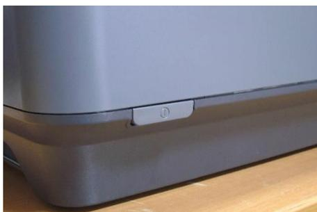
IRGB-6500 は、電源投入時に光源の光量に応じて校正（キャリブレーション）を行います。Ready（緑色）ランプが点滅している間は、使用できません。Ready ランプが連続点灯状態になりましたら次に進みます。
