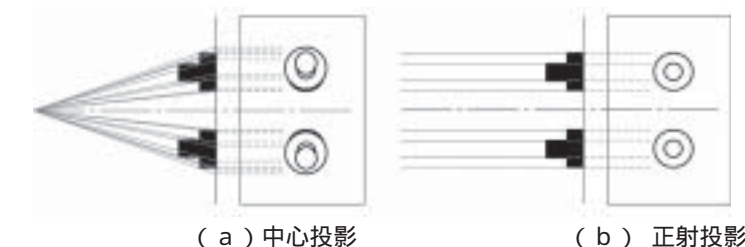
図1 中心投影と正射投影の模式図
