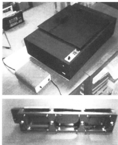
図3 マルチバンドイメージスキャナの外観(上)と、バンドパスフィルタホルダ(下)
